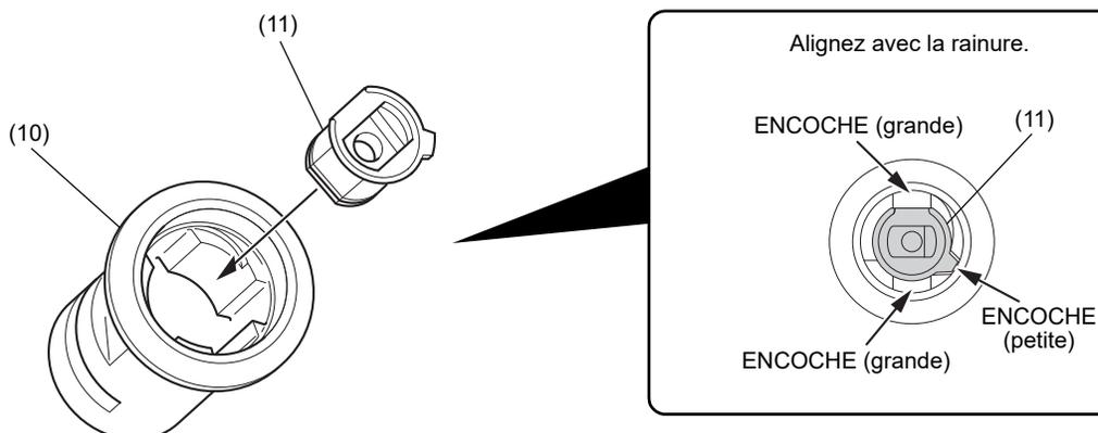
15. Montez le barillet interne en faisant glisser le contrepois de butée le long du guide d'insertion tout en le faisant tourner.
